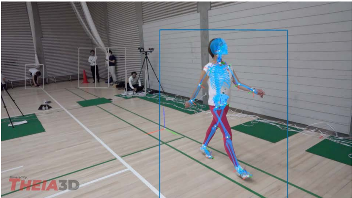
図 III-2-4 Theia3D アプリの分析結果. アプリの分析によって映像内のヒトが認識され,長方形の枠で囲われている.複数台のカメラの分析結果から,映像内でメインとなるヒトをアプリが認識し,骨格モデル(青色)が当てはめられて表示されている.
